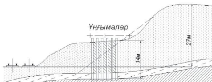
3.5.3-сурет – Карьер беткейі тау жыныстарын тұрақты электр өрісімен нығайтудың схемасы
